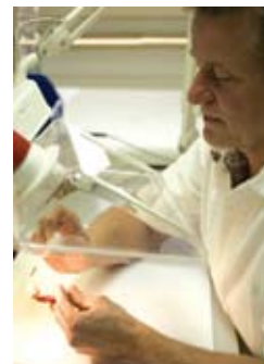
Εικόνα 1. Διάταξη παραγωγής κελυφίων από αρχείο 3D μοντέλου με χρήση laser στα εργαστήρια της Audioservice Γερμανίας.
