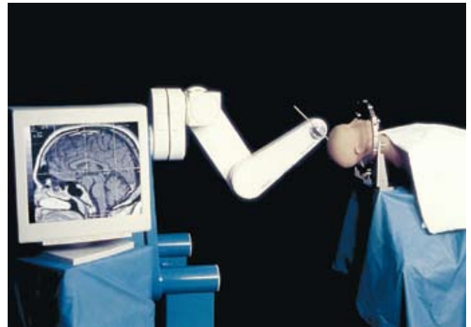
Εικόνα 2. Συνδυασμός ρομποτικού συστήματος και MRI.
